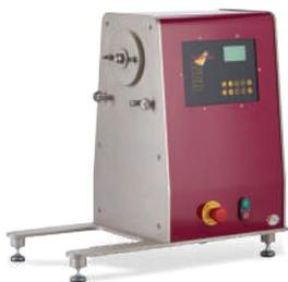
El motor universal UAM es el componente clave del sistema de planta piloto Pharmag, diseñado para una amplia gama de accesorios con brida utilizados en las industrias farmacéutica, química, alimentaria y cosmética. Es ideal para aplicaciones de I+D y producción en lotes pequeños, incluyendo batidoras, mezcladoras, granuladores, peletizadoras y equipos de dosificación. Su diseño permite cambiar accesorios de forma rápida y eficaz, y conectar periféricos como pedales y dispositivos de seguridad.
