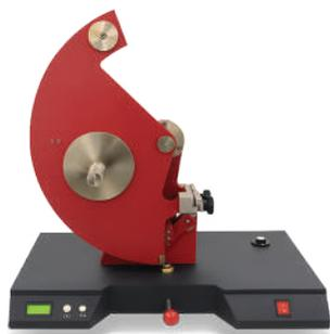
**Equipo para medir la resistencia al desgarro en diversos materiales**
