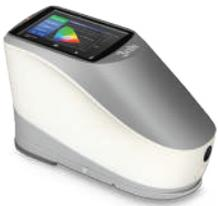
Espectrofotómetro portátil con geometría 45°/0° para medición de color en plásticos, pinturas, impresiones y textiles. Ofrece repetibilidad cromática  $\Delta E^*_{ab} \leq 0.08$  y rango espectral de 400–700 nm. Cuenta con pantalla LCD, diseño ergonómico y almacenamiento interno de datos. Cumple con estándares internacionales CIE y proporciona mediciones confiables a bajo costo operativo.
