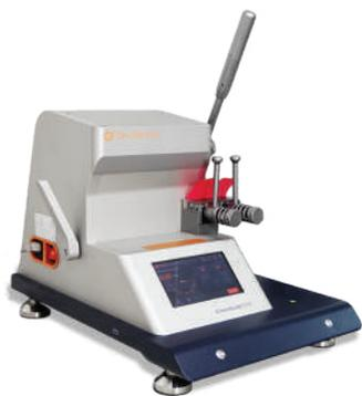
El probador de desgarro Elmendorf evalúa la resistencia al desgarro de telas mediante un método de desgarro de péndulo. El péndulo cae desde una altura específica, convirtiendo la energía almacenada en movimiento. El dispositivo corta la tela y mide la fuerza necesaria para rasgarla hasta una longitud determinada, lo que permite determinar la resistencia al desgarro del material. Este probador es ideal para analizar la durabilidad de diversos tejidos frente al desgarro.
