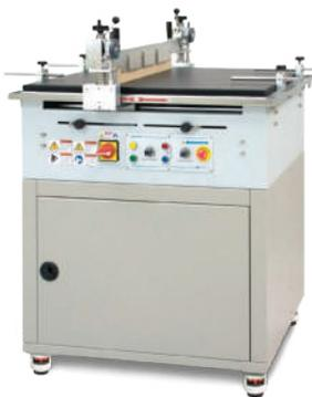
La máquina de serigrafía DL-2015SP es semi-automática y permite ajustar la inclinación de la rasqueta. Su mesa es de cuero impermeable y lavable, lo que facilita su mantenimiento. Incluye un calibrador digital de grosor con resolución de  $0.01\text{ mm}$  ( $10\text{ }\mu\text{m}$ ), y permite ajustar la velocidad y la distancia de impresión. La máquina ofrece la opción de impresión con rasqueta de goma o barra electromagnética.
