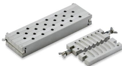
Están diseñados para supositorios rectales y glóbulos vaginales en tamaños estándar de 24, 30, 48, 60, 100 o 150 cavidades con capacidades de 1 a 8 g. Fabricados en duraluminio (AlCu4Mg1), su interior está recubierto con resina de silicio para evitar el contacto del material moldeado con el metal, garantizando inercia y seguridad en el proceso. Este diseño asegura una funcionalidad y calidad duraderas, respetando las necesidades de la práctica farmacéutica y médica.
