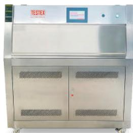
**Equipo para simular y acelerar el envejecimiento de materiales mediante UV**
