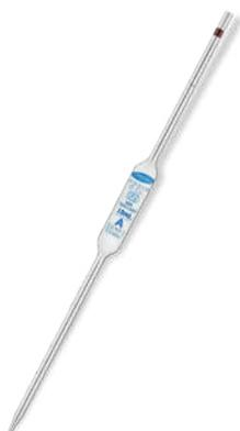
**Pipeta volumétrica Clase A con marca única, vidrio borosilicato y certificado trazable acreditado para precisión.**
