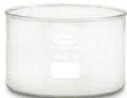
Plato de cristalización sin pico vertedor, elaborado en vidrio borosilicato de alta resistencia térmica y química. Utilizado para evaporar solventes, cristalizar compuestos y contener muestras en procesos de laboratorio. Disponible en diferentes diámetros y capacidades, es un elemento básico en laboratorios educativos, farmacéuticos, químicos y de investigación científica.
