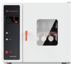
La máquina de teñido de laboratorio por infrarrojos InfraDye está diseñada para producir muestras de teñido de forma rápida y a bajo costo. Este equipo es esencial para reducir los errores en el proceso de teñido, ya que permite a los fabricantes textiles probar muestras antes de teñir grandes lotes. Además, los laboratorios de teñido de tejidos utilizan esta máquina para realizar estudios sobre el proceso de teñido, mejorando la precisión y eficiencia del mismo.
